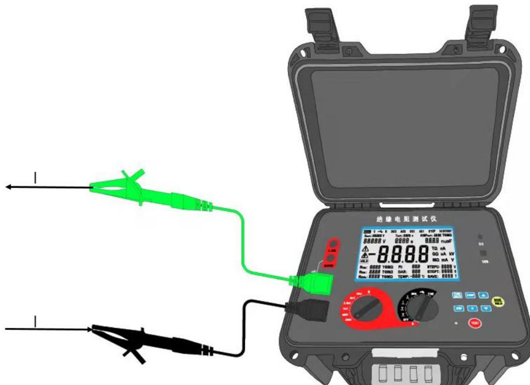
图 15 电流测量接线图
