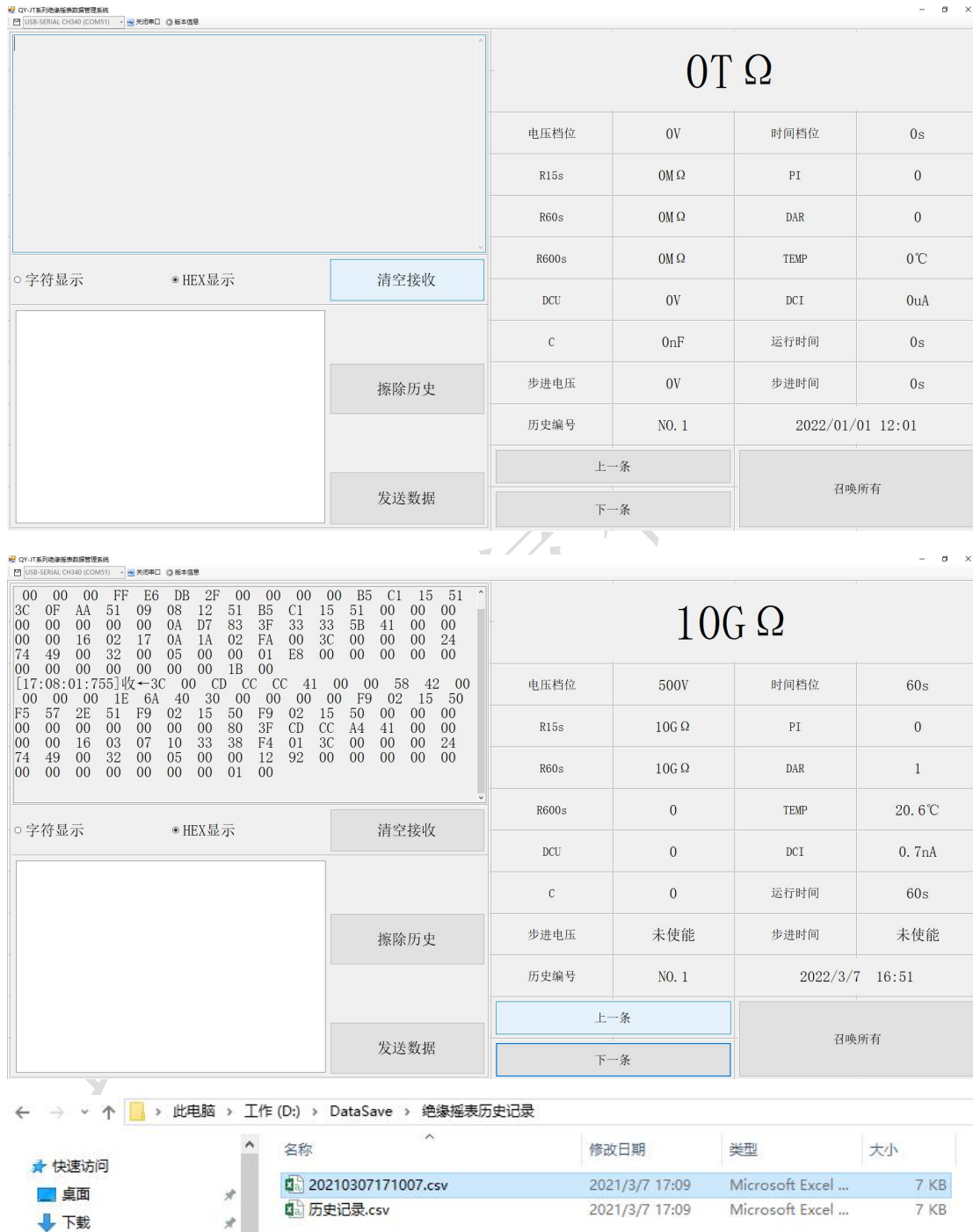
图 18 上位机界面及数据存储路径
